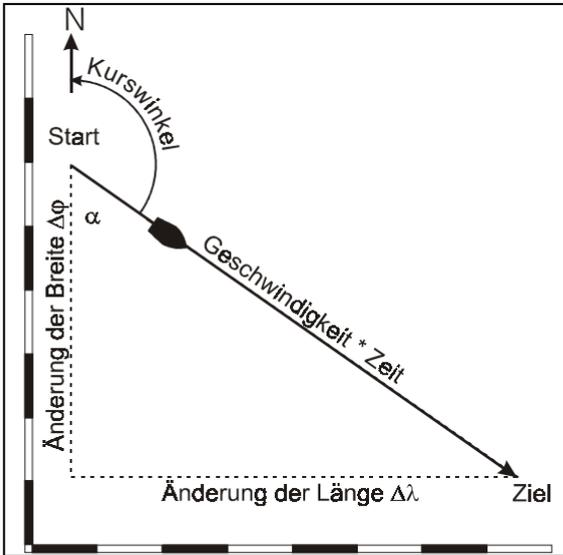
Abbildung 67: Berechnen des Koppelortes bei  $rwK > 90^\circ$
