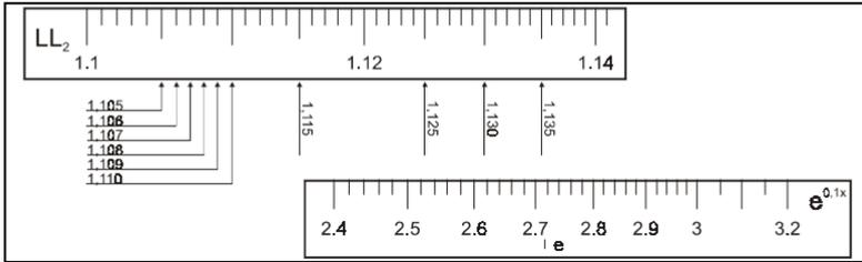
Abbildung 46: Die Enden der LL<sub>2</sub>-Skala
