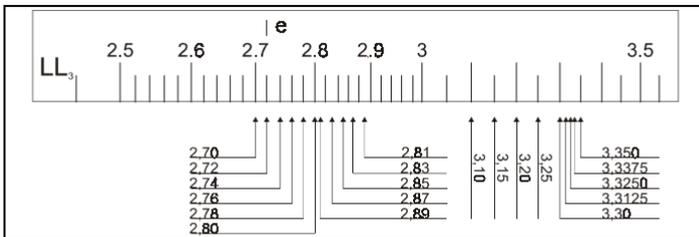
Abbildung 47: Die linke Seite der LL<sub>3</sub>-Skala
