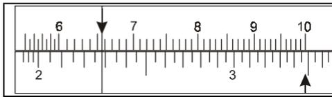
Abbildung 50: Die Multiplikation mit dem Rechenschieber
