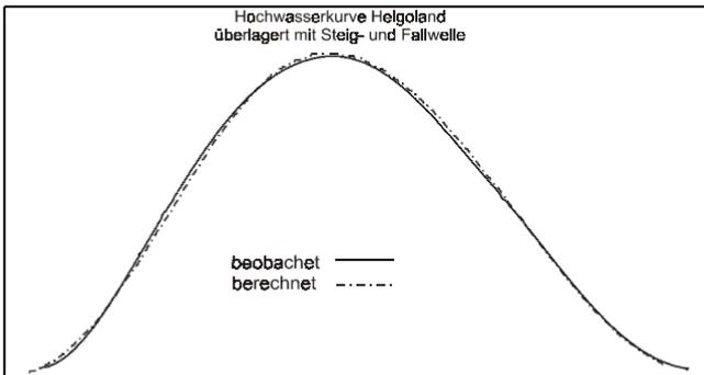
Abbildung 110: Fehlervergleich Tidenkurve 1 (Abbildung 103)
